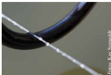
Die glatte Oberfläche ist das Ergebnis einer speziellen Oberflächenversiegelung
